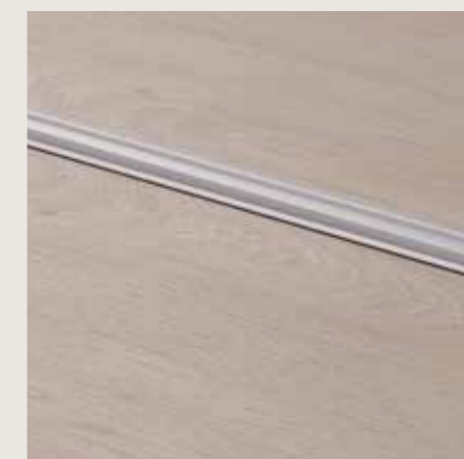
MULTIFUNKTIONEL PROFIL SØLV 1860 × 47 × 16 mm Pergo-multifunktionsprofilen kan nivellere højdeforskelle, så der opnås en jævn overgang til enhver anden gulvtype. Velegnet til højdeforskelle på 0–12,3 mm. Overflade: aluminium. PGPRSILV
